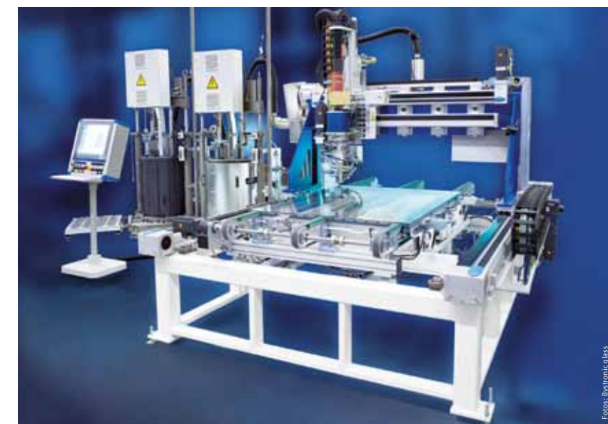
Der beim Versiegeln von Isolierglaseinheiten bewährte horizontal arbeitende photovoltaic TPA (Thermo Plastic Applicator) wurde für das automatische Abdichten von Solarmodulen mit Butyl weiterentwickelt
